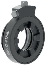
1. Beim Einsetzen der Dichtscheibe in das reCool® muss die Beschriftung der Dichtscheibe von hinten her lesbar sein. Dichtscheibe in die Spannmutter einlegen und nach vorne drücken, bis ein deutliches Klicken zu hören ist. Jetzt ist die Dichtscheibe richtig in der Spannmutter eingesetzt. Die richtig montierte Dichtscheibe ist vorne mit der Spannmutter bündig.
